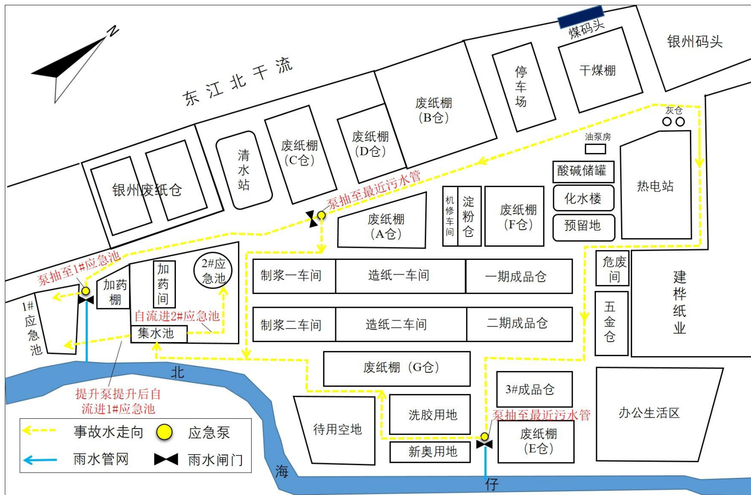
企业事故废水收集管网图
